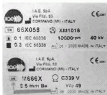
Рис. 3.2. Пример шильды рентгеновской трубки с указанием толщины фильтрации
